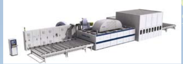
รูปที่ 4 แสดงเครื่องจักรที่ใช้อบแข็งกระจกแผ่นเรียบ
